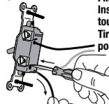
**Fils à l'arrière :** Insérer un tournevis. Tirer sur le fil pour le sortir.
