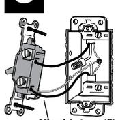
**UNIPOLAIRE :** Les fils recouverts sont raccordés à deux vis de la même couleur. Remplacer par un gradateur UNIPOLAIRE. Voir l'étape 5a.
