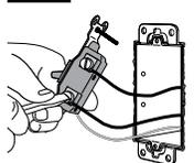
**Bornes à vis :** Tourner les vis pour les desserrer.
