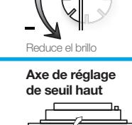
D. Encienda y apague las luces. Si las luces no se encienden o no fueran estables, gire levemente en sentido horario el dial de ajuste fino de la intensidad mínima hasta que no haya parpadeo.
