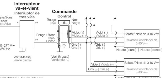
REMARQUE : Pour les applications avec un bruit électrique excessif, des fils de 0-10 V== doivent être tirés dans une conduite séparée du secteur.
