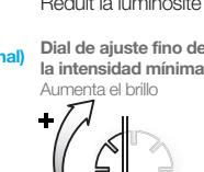
C. Con las luces encendidas y el control deslizante en el nivel de luz más bajo, gire el dial de ajuste fino de la intensidad mínima en sentido antihorario hasta que no haya parpadeo.
