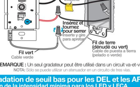
**REMARQUE :** Un seul gradateur peut être utilisé dans un circuit va-et-vient.
