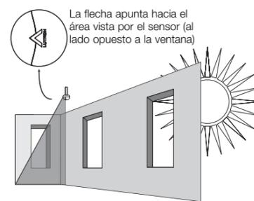
**Paso 2: Montaje del Sensor de luz natural**
