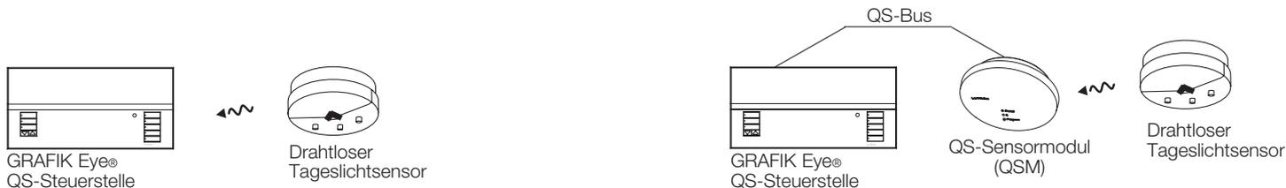
Die folgenden Schritte sind zur Programmierung von Tageslichtsensoren mit einer GRAFIK Eye® QS-Steuerstelle notwendig. Die folgenden Seiten enthalten Anweisungen für die einzelnen Schritte.
