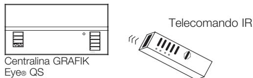
È inoltre possibile collegare un ripetitore a IR con alimentatore esterno ai morsetti per IR sulla centralina GRAFIK Eye® QS per consentire il controllo remoto mediante IR. Questo è utile per utilizzare dispositivi di altre marche con la centralina GRAFIK Eye® QS (ad esempio, applicazioni home theater). Un elenco completo dei comandi di programmazione a IR della centralina GRAFIK Eye® QS, è disponibile all'indirizzo [www.lutron.com/qs](http://www.lutron.com/qs).
