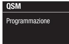
1. Tenere premuto il pulsante Programmazione sul QSM per 3 secondi per entrare in modalità programmazione. Verrà emesso 1 bip e il LED di stato inizierà a lampeggiare. Il display informativo sulla centralina GRAFIK Eye® QS indicherà che il QSM è in modalità programmazione.
