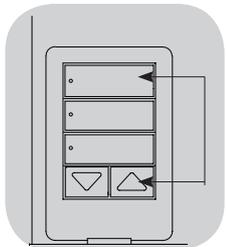
In qualsiasi momento mentre ci si trova in modalità impostazione limiti, è possibile spostare contemporaneamente tutte le tende al limite di apertura corrente premendo due volte il pulsante superiore (o al limite di chiusura corrente premendo due volte il pulsante inferiore).
