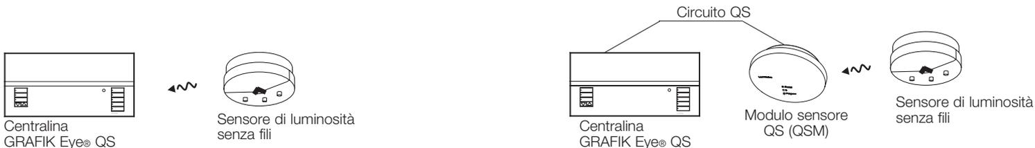
Per la programmazione dei sensori di luminosità con una centralina GRAFIK Eye® QS, procedere come descritto di seguito. Nelle pagine seguenti sono riportate istruzioni dettagliate per l'esecuzione di ciascun passaggio della procedura.
