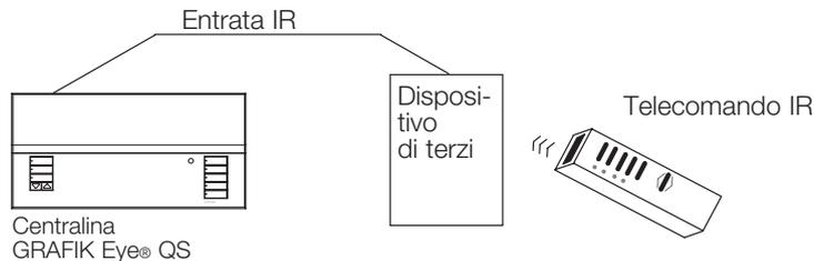
Un telecomando a IR può inoltre controllare indirettamente la centralina GRAFIK Eye® QS tramite un ricevitore a IR QS IR Eye o Lutron® collegato a un modulo sensore (QSM) per controllare il livello di illuminazione di una zona specifica o per il controllo delle scene. Prima di poter essere riconosciuti da un sistema GRAFIK Eye® QS, è necessario che il ricevitore e il sensore a IR QS vengano associati alla centralina GRAFIK Eye® QS.
