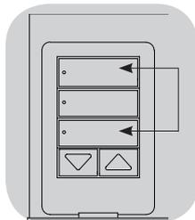
1. Nella colonna tende della quale si vuole modificare i livelli predefiniti, tenere premuti simultaneamente i pulsanti superiore e inferiore. I LED accanto ai pulsanti lampeggeranno. Le EDU dei sistemi di oscuramento finestre assegnati si porteranno al limite di chiusura, mentre quelle dei sistemi non assegnati si porteranno al limite di apertura.
