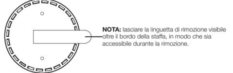
**NOTA:** lasciare la linguetta di rimozione visibile oltre il bordo della staffa, in modo che sia accessibile durante la rimozione.
