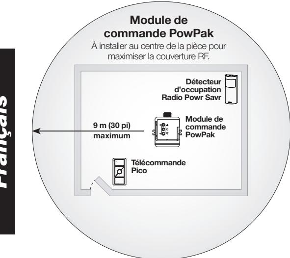
Tous les transmetteurs sans fil doivent être installés à moins de 9 m (30 pi) du module de commande PowPak avec la technologie EcoSystem.
