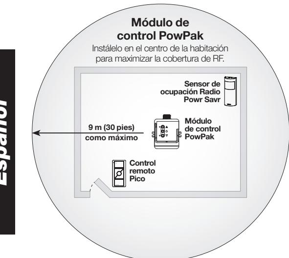
Todos los transmisores inalámbricos deben ser instalados a menos de 9 m (30 pies) del módulo de control PowPak con EcoSystem.
