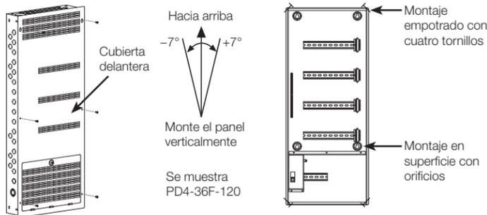
3. **Monte el panel para embutir** utilizando uno de los siguientes métodos (no se suministra la tornillería de montaje):
