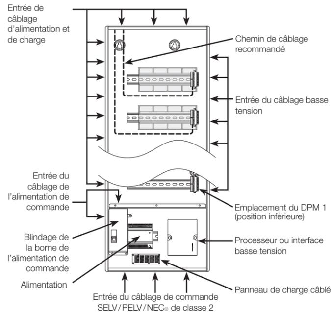
**5. Câblage de l'alimentation de commande (panneaux de commande seulement).**
