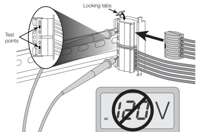
**8. Test all load wiring.**
