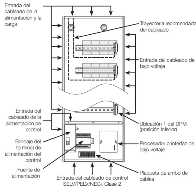
5. **Cableado de alimentación del control (paneles de control únicamente).**
