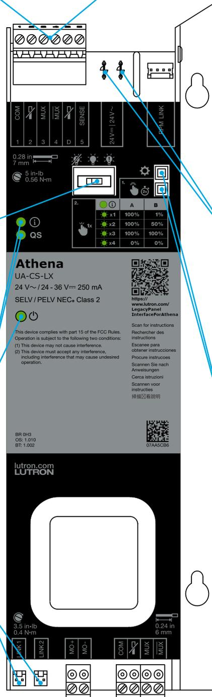
注意：通电时，电源 LED 应始终亮起。请勿将 LED 用作面板电源指示灯。在处理端子或连接器之前，请务必断开面板的电源。
