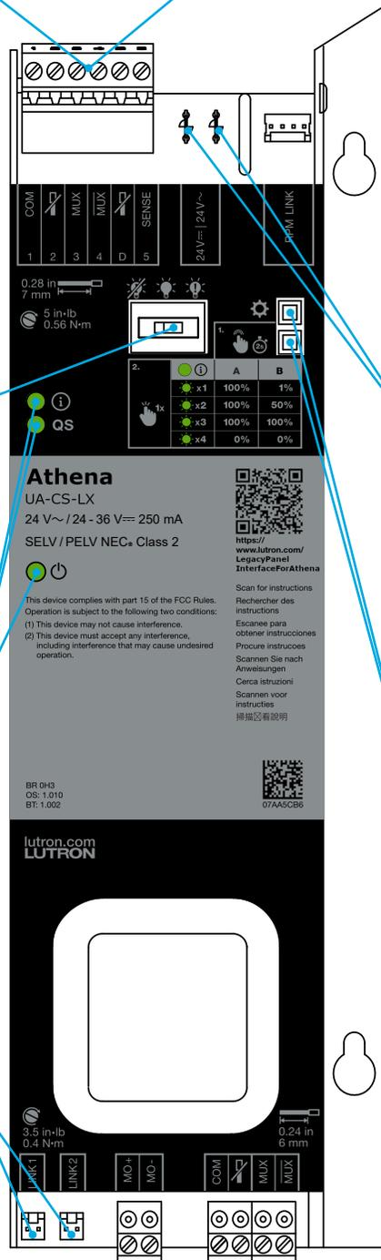
**NOTA:** El LED de la alimentación eléctrica deberá siempre estar encendido cuando se aplica la misma. No utilice el LED como indicador de alimentación eléctrica del panel. Siempre desconecte la alimentación eléctrica del panel antes de manipular terminales o conectores.
