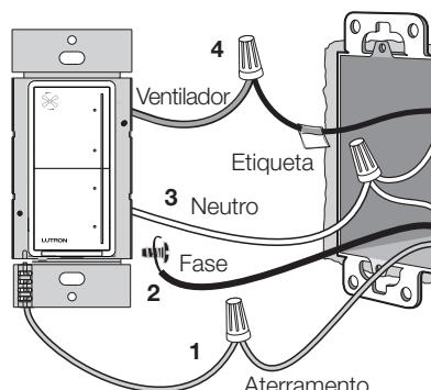
1 Conecte o fio de cobre desencapulado (ou verde) de aterramento da caixa de embutir ao fio verde do controle do ventilador usando um conector.
