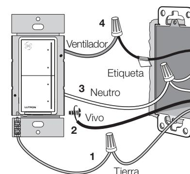
1 Conecte el cable de cobre pelado (o verde) de "tierra" desde la caja de empotrar al cable verde del control del ventilador utilizando un conector de cables.
