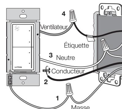
1 Raccordez le fil de cuivre dénudé (ou vert) « masse » du boîtier d'encastrement au fil vert de la commande du ventilateur à l'aide d'un connecteur de fils.
