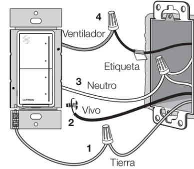
1 Conecte el cable de cobre pelado (o verde) de "tierra" desde la caja de empotrar al cable verde del control del ventilador utilizando un conector de cables.
