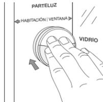
**NOTA:** El adhesivo suministrado está diseñado para el montaje sobre parteluces de aluminio únicamente. Para un montaje seguro en otras superficies, se deberá agregar un tornillo de fijación tal como se muestra en el paso 4. (Si la superficie del montaje fuera de aluminio, omita el paso 4 y continúe directamente al paso 5.)
