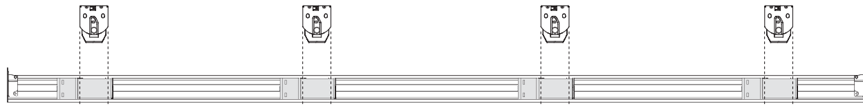
Stores de 1829 mm (72 po) à 2438 mm (96 po) de largeur : 4 bobines, 4 supports
