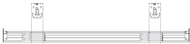
Stores jusqu'à 1143 mm (45 po) de largeur : 2 bobines, 2 supports
