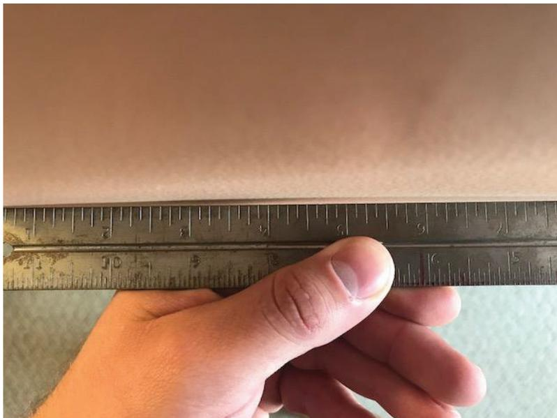
Foto da borda reta usada para avaliar o nivelamento da parede.
