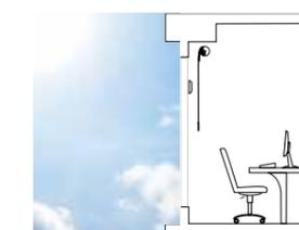
**CIELO BRILLANTE:** las cortinas se mueven a una posición predeterminada para minimizar el contraste del cielo brillante
