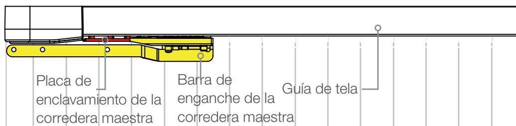
**Desenganchada:** Cuando se abre manualmente la cortina, la barra de enganche de la corredera maestra se desengancha de la placa de enclavamiento.
