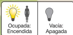
**Los sensores de presencia** apagan las luces e interrumpen la energía inactiva de los electrodomésticos cuando alguien se retira del lugar.
