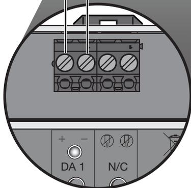
El módulo de alimentación eléctrica DALI® suministrará alimentación al bus DALI® de forma independiente. El bus admite un máximo de 64 cargas direccionables digitales compatibles con DALI®.
