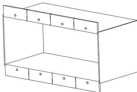
S'ajuste dans boîtier d'encastement U.S. quadruple 4-ouvertures, 76,2 mm de profondeur; Lutron P/N 241-400 ou 90,4 mm de profondeur; Lutron P/N 245-254
