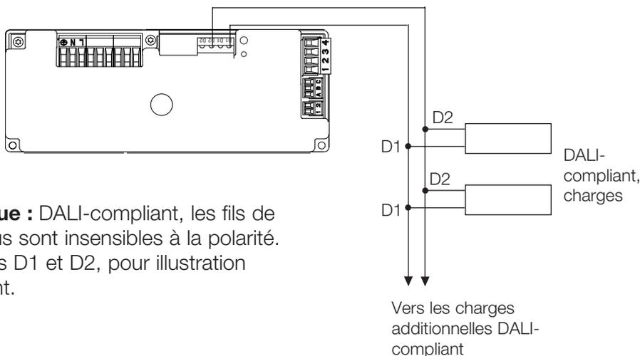
**Remarque :** DALI-compliant, les fils de liaison bus sont insensibles à la polarité. Étiquettes D1 et D2, pour illustration seulement.
