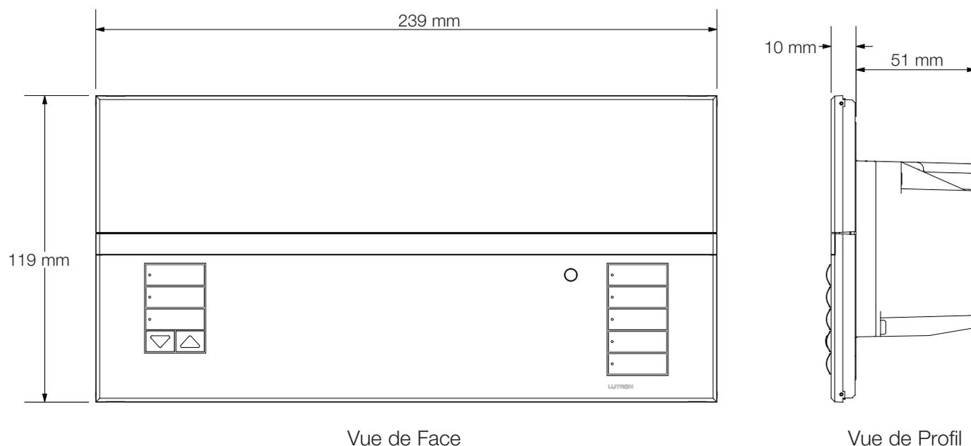
S'ajuste dans boîtier d'encastrement U.S. quadruple 4-ouvertures, 76,2 mm de profondeur; Lutron P/N 241-400 ou 90,4 mm de profondeur; Lutron P/N 245-254
