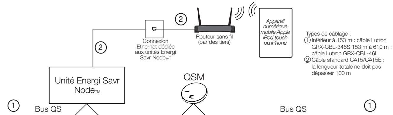
\* Remarque : Les unités Energi Savr Node™ ne sont pas conçues pour être connectées à un réseau ouvert. La connexion à un réseau ouvert pourrait engendrer des diminutions de performances et des problèmes de connectivité Ethernet.
