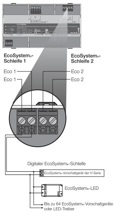
Das Leistungsverstärker-Modul mit EcoSystem® versorgt zwei unabhängige EcoSystem®-Schleifen mit Strom, die maximal 64 Vorschaltgeräte pro schleife unterstützen.
